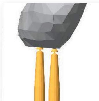
Места разрыва позволяют пользователям удалять поддержки, не повреждая модель
